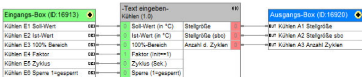
Bild 70 Logikaufbau des Bausteins Kühlen .
